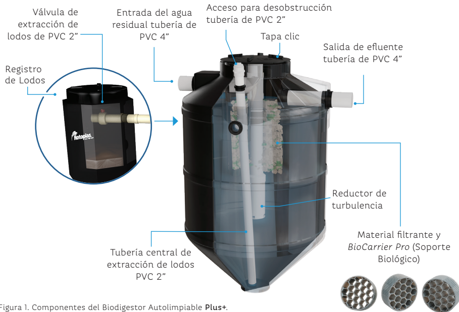
Figura 1. Componentes del Biodigestor Autolimpiable Plus+.
