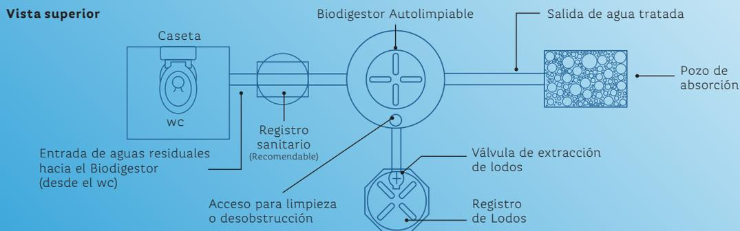
Nota: no reutilices el agua tratada, deberá ser descargada a suelo (pozo de absorción o zanja de infiltración), utilizando las recomendaciones indicadas por la NOM-006-CONAGUA-1997.
