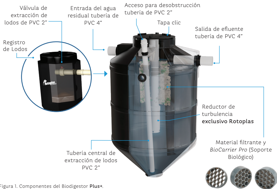
Figura 1. Componentes del Biodigestor Plus+ .
